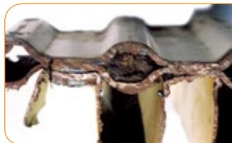
Radiateurs obstrués par des dépôts
