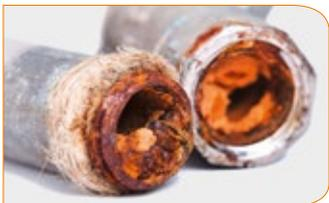
Boues et magnétite dans les tubes et les vannes
